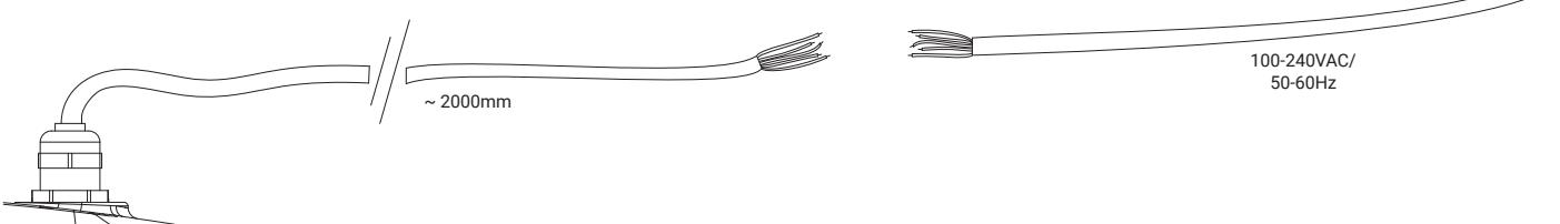
**2b.** Einfacher Anschluss der Zuleitung mit den optionalen IP65-Anschlussstecker. | Easy connection of the supply cable with the optional IP65 connector.
