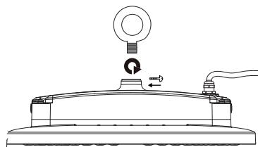
Drehen Sie die im Produktkarton enthaltene Ringschraube in das Gewinde auf der Oberseite der Leuchte. Ziehen Sie diese fest und sichern Sie diese mit der beiliegenden Sicherungsschraube. | Screw the eyebolt included in the product box into the thread on the top of the lamp. Tighten it and secure it with the added locking screw.
